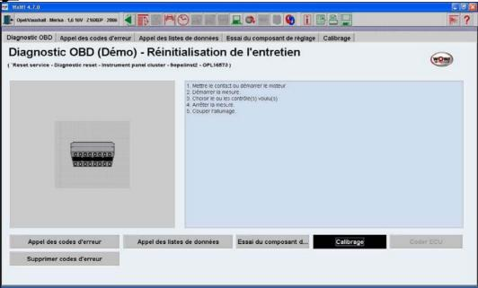
Cette fonction permet d'effectuer des réglages de paramètres (par ex. réglage de base du boitier papillon sur VAG, Reset de l'entretien etc...)
