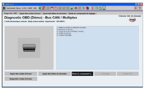
Cette fonction permet d'activer des composants connectés au système en test.
