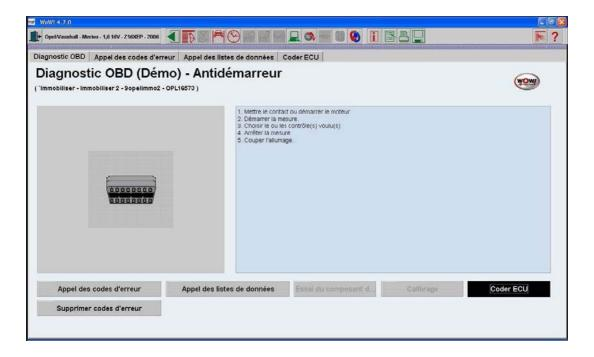
Cette fonction permet de coder des calculateurs ou des composants (injecteurs, clés, ...).
