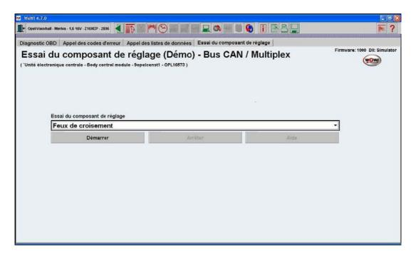
· Les tests d'actionneurs dépendent du constructeur et du système interrogé. Veuillez suivre les indications du programme pour mener à bien ces opérations.
