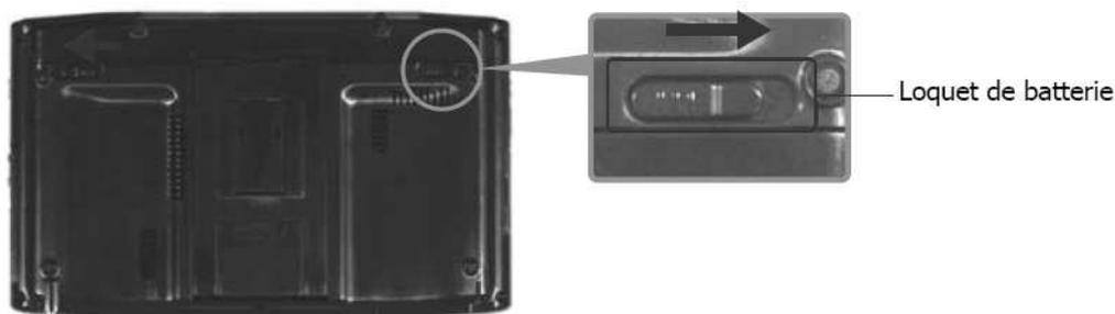
Pour réinstaller la batterie, faites-la glisser dans l'ordinateur. Les loquets se remettent en place et calent automatiquement la batterie.
