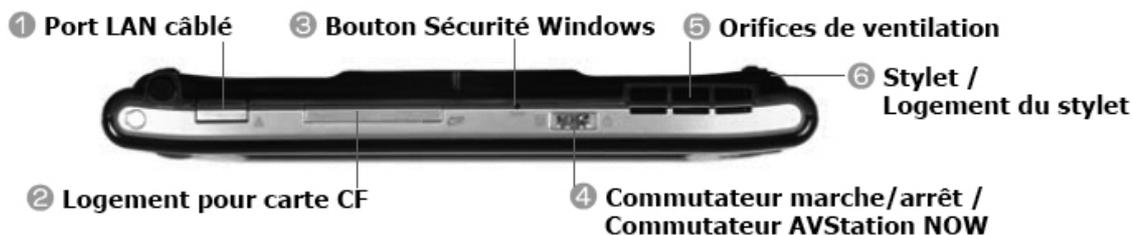
**1 Port LAN câblé** Un port auquel est connecté un câble Ethernet ; relie l'ordinateur à un réseau local.
